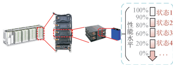
图4 储能电池舱体典型层级结构
